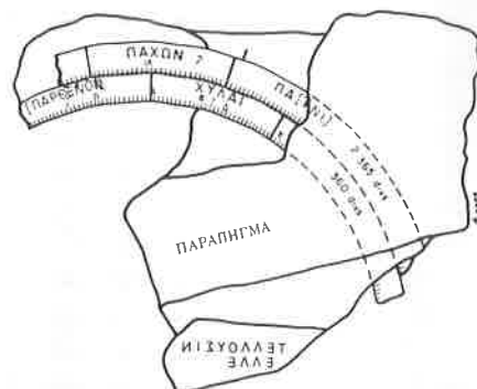
Fragment av skalorna för inställning av observationsdagen, på dosans framsida.
