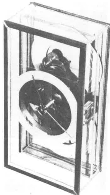
Antikythera-dosans framsida med inställningsskalor och positionsvisare. Fotografi av en modell tillverkad av urmakaren Frank Percival i enlighet med Allan Bromleys anvisningar.
