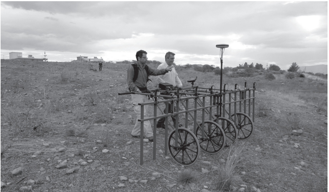
Tuna Kalayci ja Apostolos Sarris kartoittavat Ambelakian pinnanalaisia rakennusjäänteitä käyttäen magneto-metriä. Taustalla rinteessä on käytössä maatutka. Kuva: Jari Pakkanen 2016.
